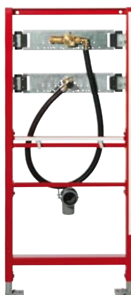
TECEprofil-Urinal-Modul mit TECE-Spülergehäuse , für den Einbau in eine TECEprofil-Vorwand, zur Aufnahme von manuellen und elektronischen Betätigungssystemen.
